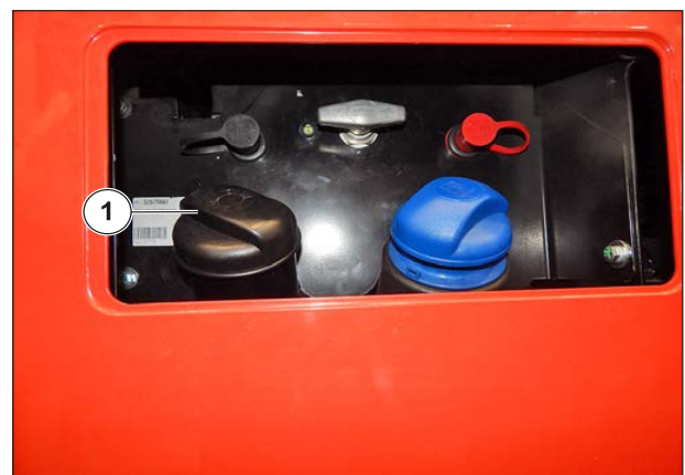
Afbeelding 121: De brandstoftank vullen
