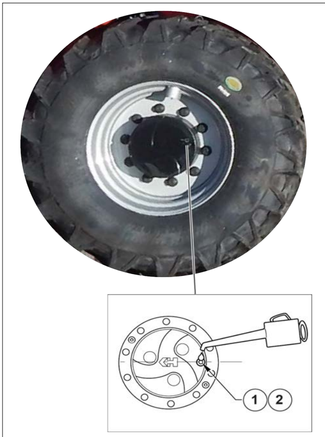
Afbeelding 162: Oliepeil van voor- en achterwielreductoren controleren
